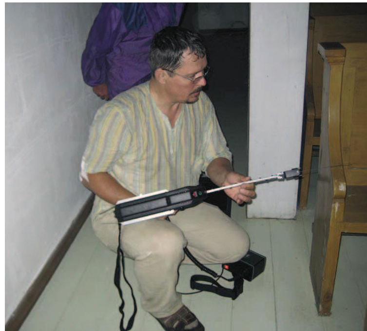
Konstruktsiooni kontrollimine resistograafiga.
